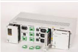
**Tischgerät für Kunden als kompletter 19" Baugruppenträger.** Aufgebaut sind: AC/DC-Konverter (Netz -> 24V), Batterieabgang mit Sicherung, Wechselrichter (DC/AC) mit Verteilung (AC) abgesichert und diverse DC-Ausgänge (5V, 12V, 24V) zur Versorgung und Pufferung von Messinstrumenten.
