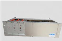
**Stromversorgungsrack für Bahnbaumaschinen.** 24V -> 110 VDC, Einschübe von Powerinnovation. 19" Rack für Einbau in Schaltschrank, Bahntauglich EN50155.
