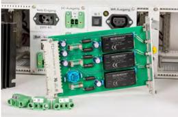
**Einschubkarte für 19" Baugruppenträger (Eurokarte).** 4TE-Alufrontplatte mit LED zur Signalisierung der Ausgangsspannung (5V, 12V, 24V). Nach Kundenwunsch auf H15-Messerleiste aufgeschaltet, mit Sicherungen für den Ausgang und EMV-Beschaltung.
