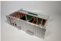
**Stromversorgungsrack für Funk-Applikationen im EVU-Bereich.** Konstruktion der komplexen Backplane, isolierter Aufbau für positive und negative Masse.
